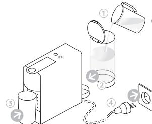
**1** **Ispirajte spemnik za vodo** prije nego ga napunite svežom vodom za piće. Stavite posudu (min. 1 L) ispod izlaza za kavu. Uključite u utičnicu.
