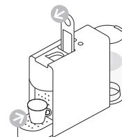
**3** **Zatvorite ručkicu** i stavite šalicu ispod izlaza za kavu. Zaprite ročico in namestite skodelico pod izhod za kavo.
