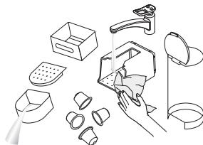
**1 Ispraznite posudu za kapanje,** bazu za kapanje i posudu sa kapsulama svaki dan. Također uklonite spremnik za vodu sa njegovim poklopcom i operite ih deterdžentom bez mirisa i isperite tiplom/vrućom vodom.
